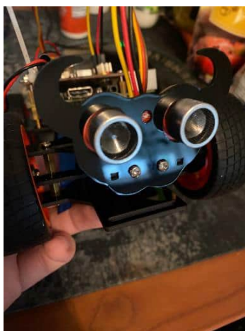
Рис 5.12 Установка датчика наближення
