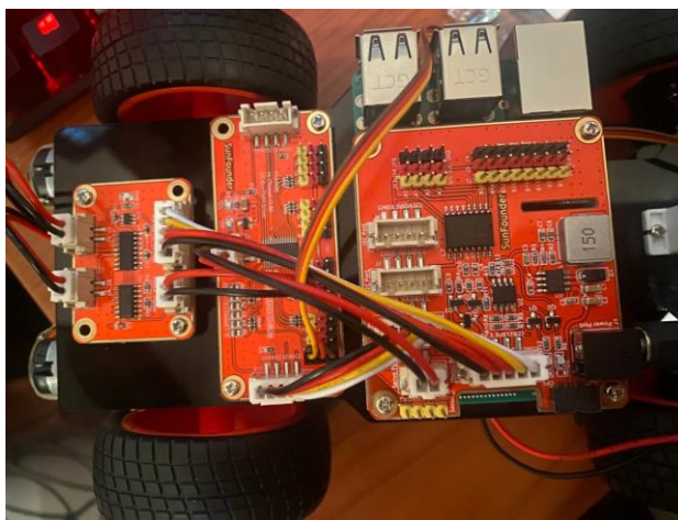
Рис 5.11 Підключення усіх необхідних кабелів
