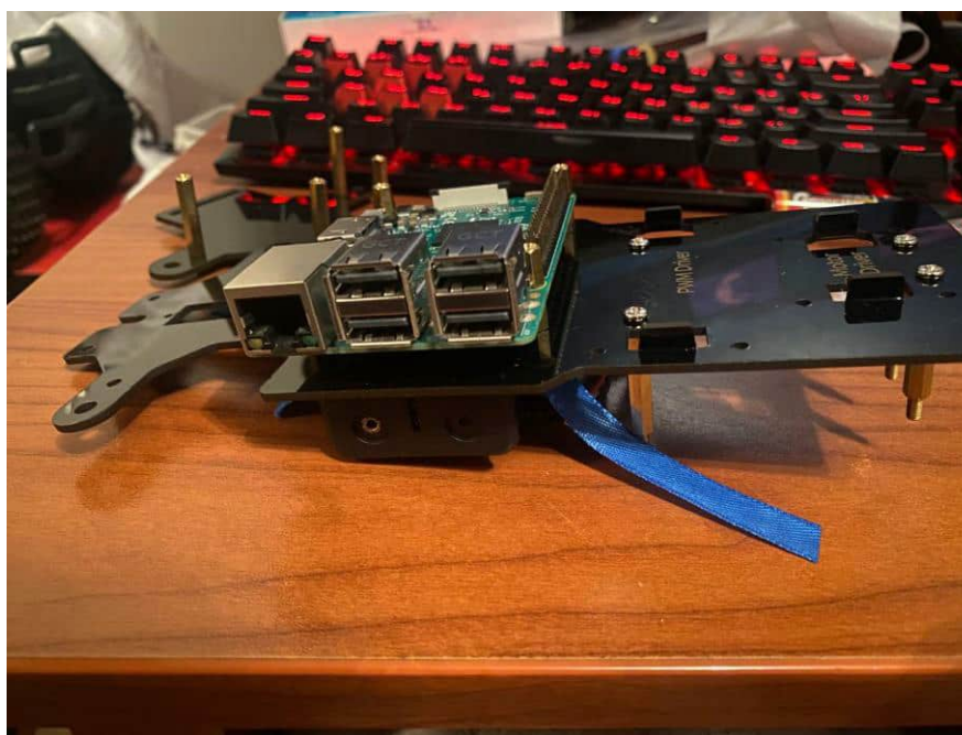
Рис 5.7 Установлення плати Raspberry Pi 3 Model B на основу шасі
