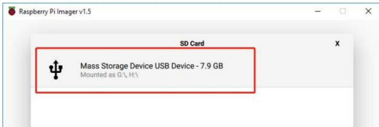
Рис 5.2 Вибір диску на який встановлюється операційна система
