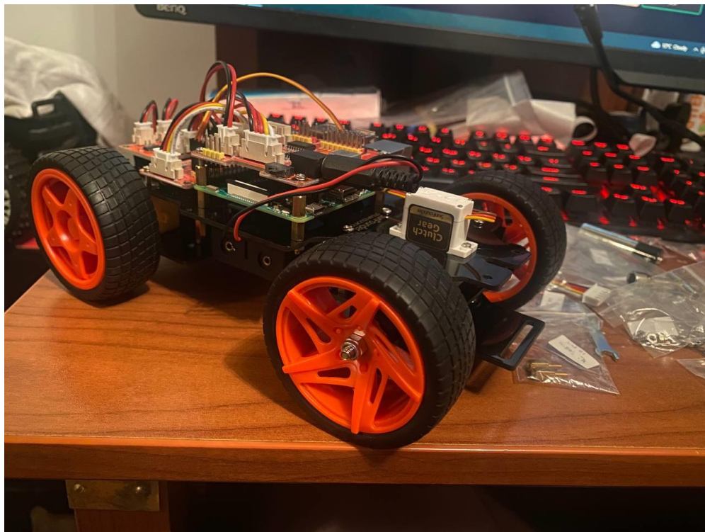
Рис 5.10 Установка коліс та сервоприводу
