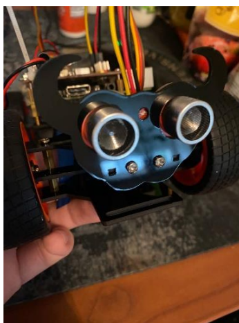
Рис 5.12 Установка датчика наближення
