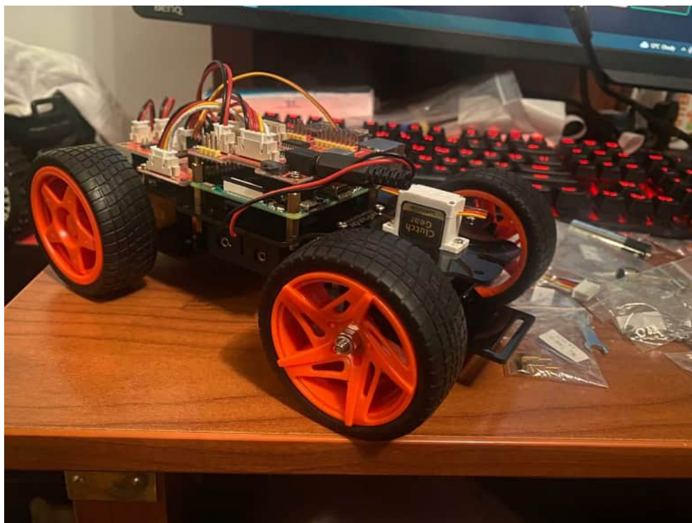
Рис 5.10 Установка коліс та сервоприводу
