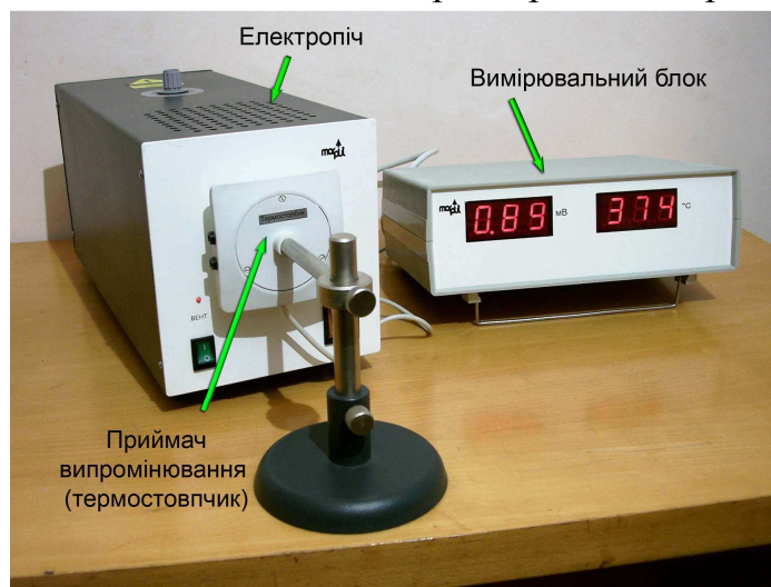
Рис. 2. Експериментальний пристрій ФПК-11 для вивчення теплового випромінювання та визначення його інтегральної інтенсивності.
